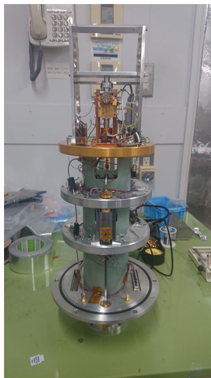
図 1. SUMIRE 用 275-500 GHz 帯受信機
