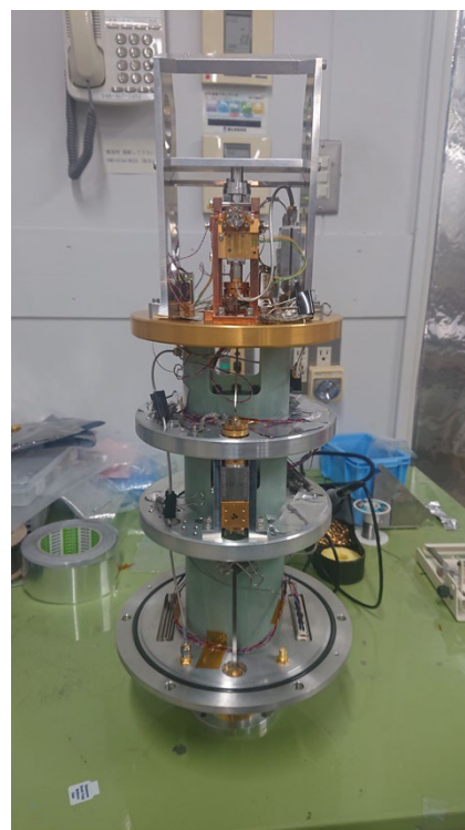
図 1. SUMIRE 用 275-500 GHz 帯受信機
